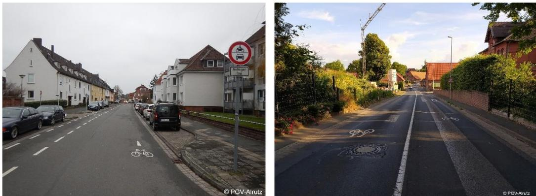
Abb. 4-4: Links: Beispiel für Einsatz eines Schutzstreifens und einer gegenüber liegenden Piktogrammreihe auf der Fahrbahn (Celle, Niedersachsen); rechts: Beispiel für den Einsatz beidseitiger Piktogrammreihen (Region Hannover)
