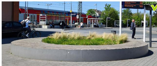
Abb. 16: Kreisförmiges Sitzpodest aus Holzpaneelen mit Stahlrahmen
