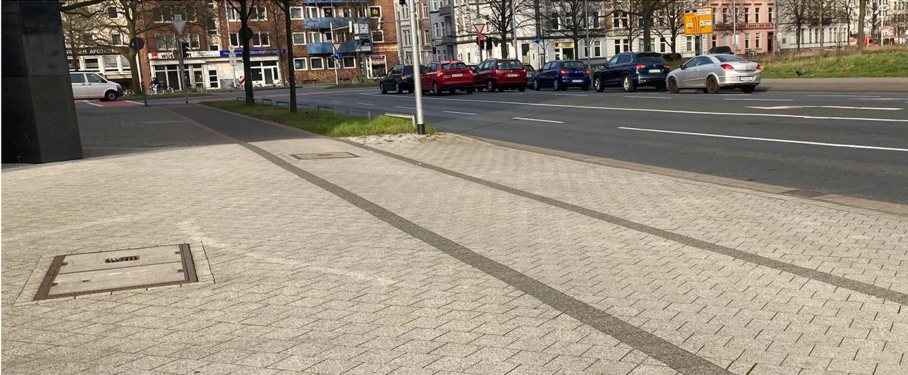
Abb. 158: Pflastersteine seitlich des Radwegs markieren Fahrspur. Die Pflasterung der Umgebung verläuft auch in der Fahrspur und schafft eine Einheitlichkeit
